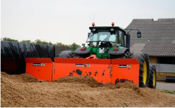
Billede 1. Billedet viser indlægning af majs i tynde lag med dozerblad, hvilket der er god erfaring med. (Foto: Peter Hvid Laursen, SEGES).
